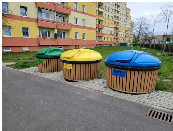
Fot. nr 1 Komplet pojemników półpodziemnych do segregacji
