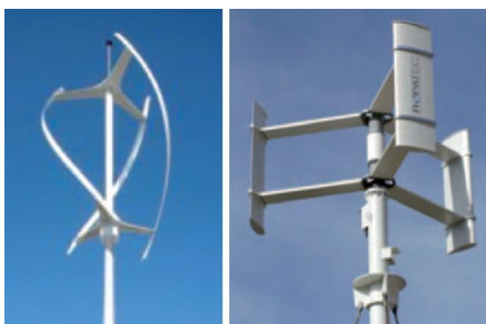
Rysunek 20. Turbiny o pionowej osi obrotu 168 .
