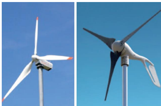
Rysunek 19. Turbiny o poziomej osi obrotu 167
